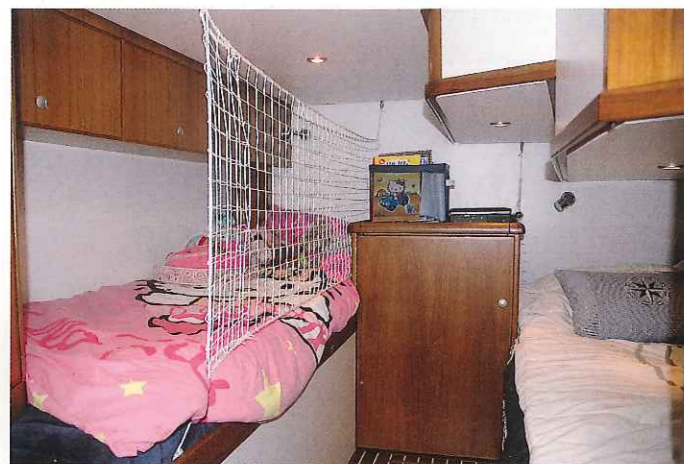
In der Gästekabine, deren Höhe zwischen 155 und 218 cm variiert, wurden ein Einzelbett und eine 140 cm breite Doppelkoje angeordnet
