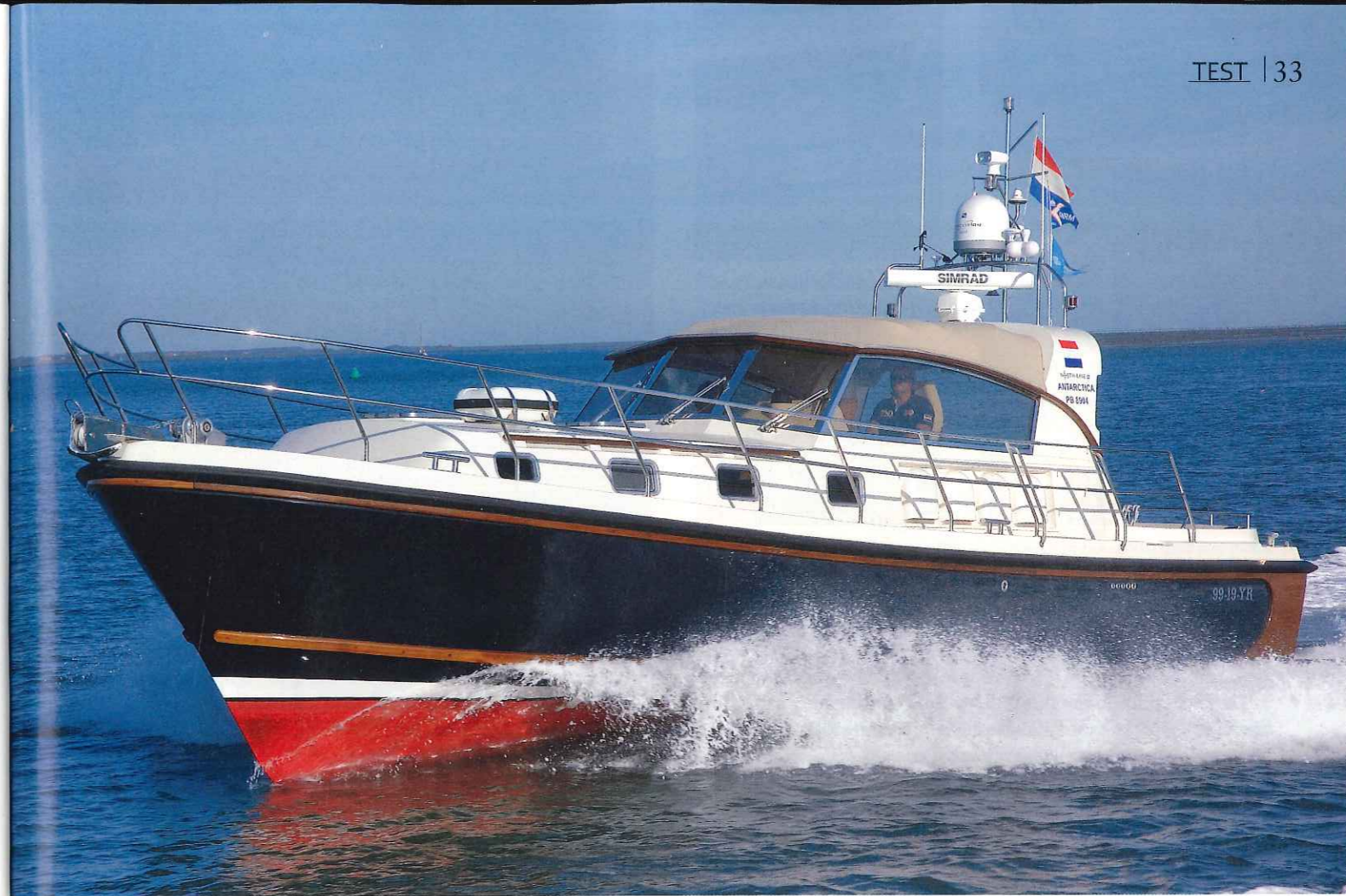
Die 13,80 m lange und 4,15 m breite North-Line 42 während des Tests im Wattenmeer querab der Insel Terschelling. Das Boot erreicht 26,5 kn
