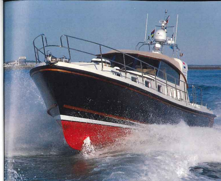
Ein Lotsenboot stand Pate: Die North-Line verfügt über einen hervorragend laufenden Rundspant-Rumpf mit scharfer V-Kielung des Bugs
